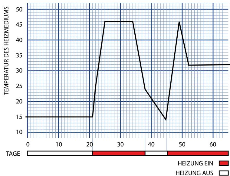
Diagramm 1 – Beispiel des Anlaufdiagramms der Fußbodenheizung
